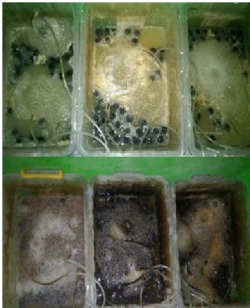
Gambar 3.18. Reaktor Biodigester Imobilisasi Bakteri dan Alga
